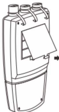
**i** 當電池電量耗盡時，可將儀器連接至電腦的 USB 電纜作為臨時電源，或使用一個 5V 電源變壓器連接外部電源。如果要進行上述操作，務必取出儀器內安裝的電池。
