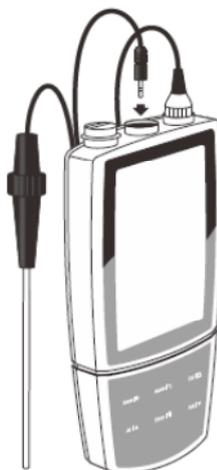
ATC 圖示出現在螢幕右側，進入自動溫度補償模式。
