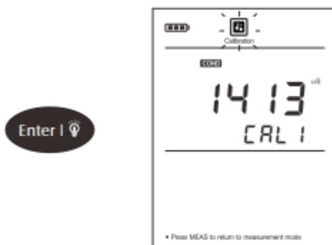
6. 等待數值穩定後，螢幕顯示 END，返回測量模式，校正完成。
